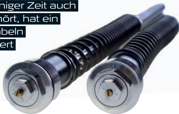
Die beiden Cartridges: Rechts mit Druckstufendämpfung, links mit Zugstufe
