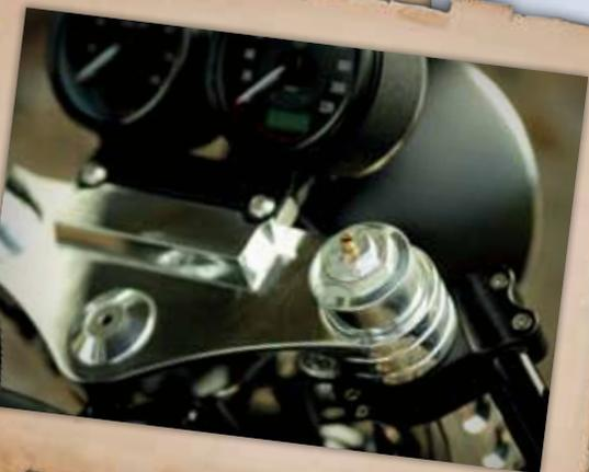
Cartridge für 41mm Standrohrdurchmesser, alu-poliert
